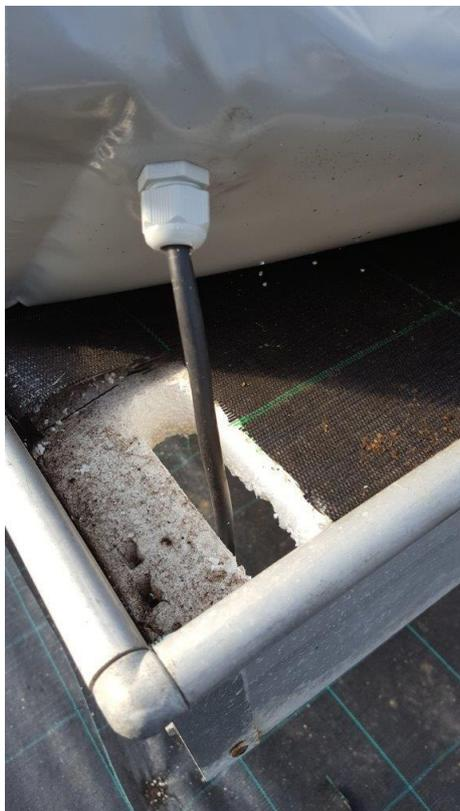
7. Collegare ogni termofascia al controllo di temperatura mediante connessione specifica e/o prolunga. Ogni controllo di temperature deve essere utilizzato solo con termocoperte dello stesso modello e potenza (stesso codice).
